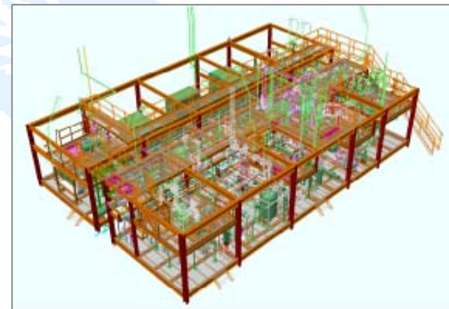
ブラジルに建設されるGTL実証設備
